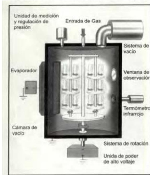
Figura 2. Recubrimiento duro de las herramientas de producción en serie mediante la Deposición Física de Vapor" PVD". (Berajano, 2000)
